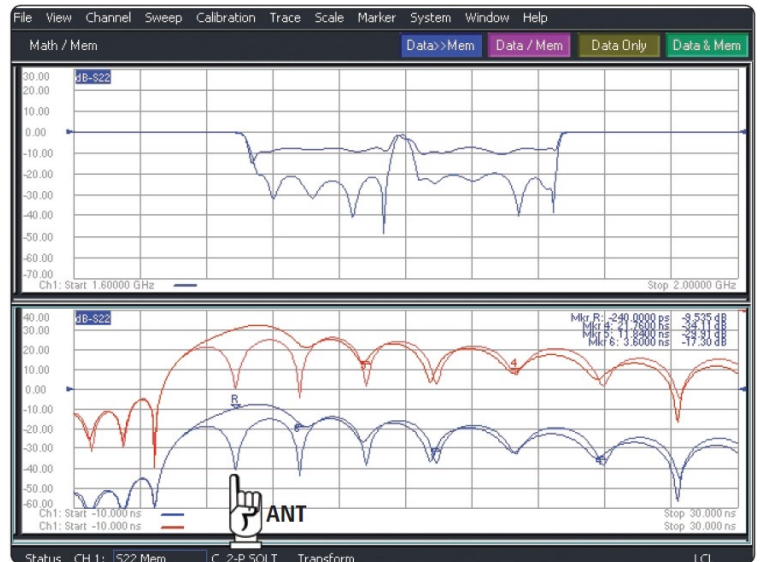
Abbildung 14. Beim Abstimmen des gemeinsamen ANT Resonators zeigt sich eine Änderung der Kurve hauptsächlich bei der ersten Nullstelle. Dadurch kann der ANT Resonator bestimmt werden und die Frequenz dieses Resonators kann bestimmt werden, indem man die Mittenfrequenz des VNAs so verändert, bis diese Nullstelle minimal wird.
